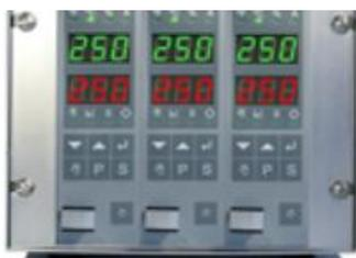
Система SR11 предназначена для контроля температуры в формах для литья под давлением с подогреваемыми каналами, а также для других систем обработки пластмасс.
